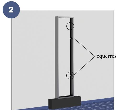
Placer «la jupe» du produit sur le support de manière à ce que les 4 petites équerres soient du côté du mur. Vérifier à l'aide d'un niveau que le produit est bien positionné.
