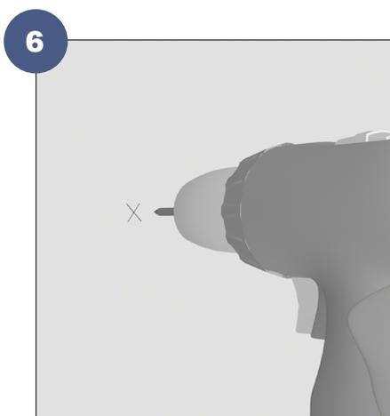
À l'aide d'une perceuse, percer le mur là où se trouvent les repères. Utiliser un foret dont le diamètre est adapté aux chevilles que vous utiliserez.
