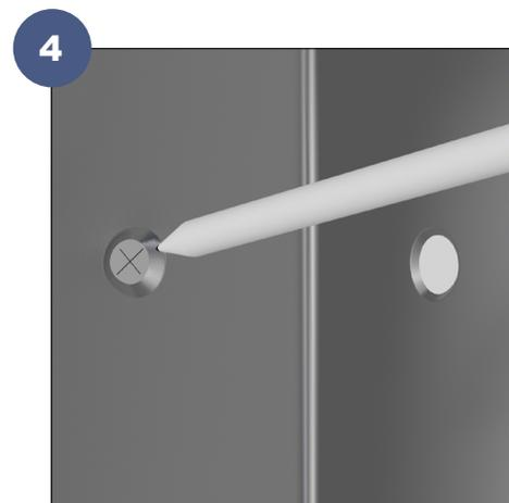
Ouvrir le combiné et faire des repères à l'aide d'un marqueur fin dans les 4 trous de fixation se trouvant à l'arrière du combiné.
