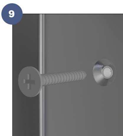
Ouvrir le combiné et visser les 4 vis dans les chevilles. Attention : si le support ne touche pas la tôle : ne pas visser à fond car ceci déformerait la tôle et risquerait d'endommager le produit.
