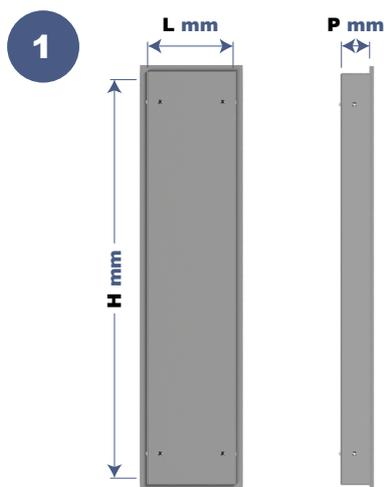
Mesurer la hauteur (H), la largeur (L) et la profondeur (P) d'encastrement du produit.
