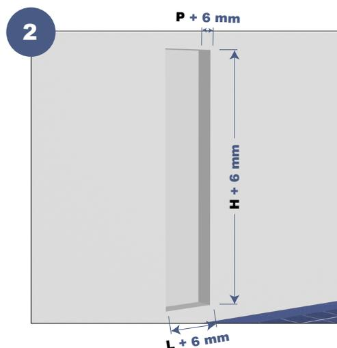
Vérifier que l'ouverture dans le mur est égale à H + 6 mm (pour la hauteur), L + 6 mm (pour la largeur) et P + 6 mm (pour la profondeur).
