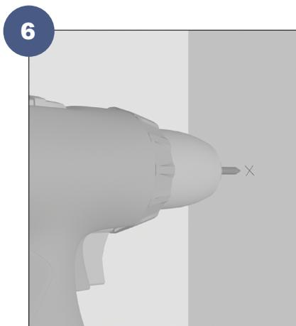
À l'aide d'une perceuse, percer le mur là où se trouvent les repères. Utiliser un foret dont le diamètre est adapté aux chevilles que vous utiliserez.
