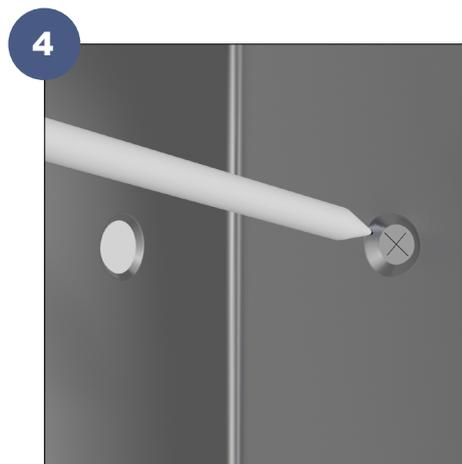
Ouvrir le combiné et faire des repères dans les trous de fixation (2 de chaque côté) à l'aide d'un marqueur fin. Les trous à l'arrière servent pour le montage en applique.
